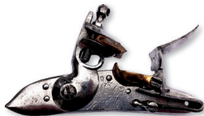
La platine n'est pas du type 1763, mais bien au modèle du 1786. Le bassinnet est en laiton avec un important garde-feu.
